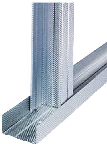
RigiProfil je nova generacija čeličnih profila za Rigips pregradne zidove. Posebnost RigiProfil-a je njegova specifično obrađena površina. Ona nastaje patentiranim postupkom pri kojem čelik prolazi kroz par nazubljenih valjaka. Na taj način materijal dobiva na čvrstoći i ima više prednosti u pogledu kvalitete i obradivosti u odnosu na standardne glatke profile. Ovakva obrada površine profilima daje i prepoznatljiv izgled.
